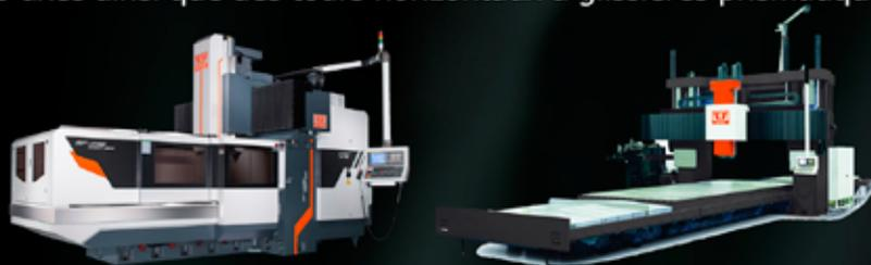
Vision Wide propose une gamme complète de centres d'usinage verticaux à portique (Cinq faces, cinq axes, à colonne fixe, à montant mobile, avec guidages prismatiques ou linéaires, changement de tête automatique...).
