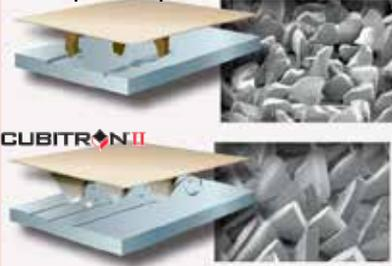
Les grains **céramiques triangulaires, calibrés et orientés** des produits Cubitron™ II se fractionnent pour garder leur forme originale affûtée. Les risques d'échauffement sont limités, la coupe est plus rapide et dure bien plus longtemps que les grains céramique classiques.
